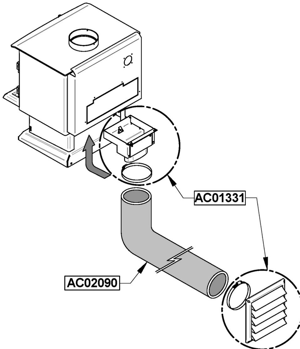
Positionnez l'adaptateur sous l'appareil. Appuyez l'adaptateur sur le fond du poêle en alignant les deux trous de fixation à ceux du coupe-chauffeur du dos. Fixez en utilisant les deux vis contenues dans l'emballage.
