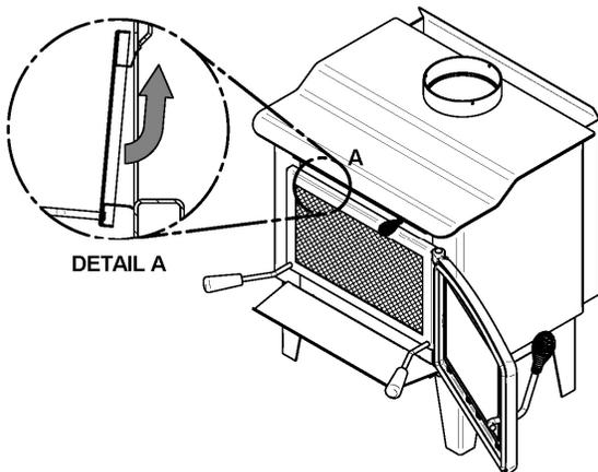
Inclinez la partie supérieure du pare-étincelle vers le haut de l'ouverture de porte. Ensuite insérez les deux crochets au haut du pare-étincelle derrière le déflecteur d'air primaire tel qu'illustré dans le (Détail A).
