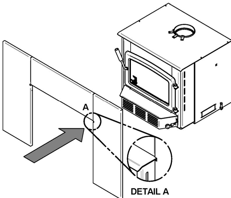
Une fois la façade assemblée, alignez les encoches, situées dans le haut de chaque côté de l'ouverture de la façade, avec le dessus de l'encastrable et poussez la façade vers le devant du foyer (voir **DÉTAIL A.**)
