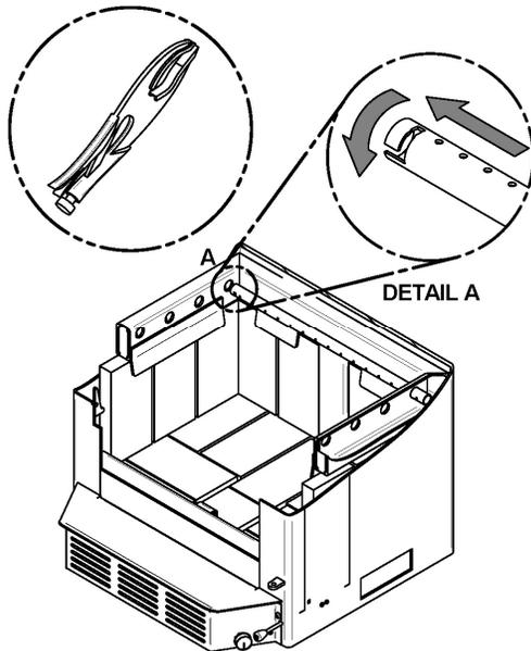
2. Alignez le chemin du tube et la dent dans le trou de la canalisation. Tenez le tube à l'aide d'une pince de serrage et suivez le mouvement décrit dans la figure ci-contre, (**DÉTAIL A**) pour le sécuriser en place. S'assurer que la dent touche le fond du chemin du tube.
