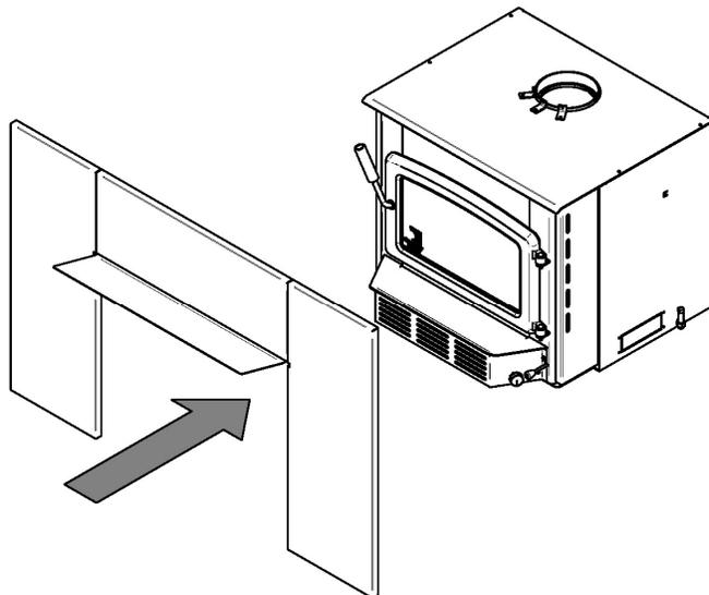
Une fois l'écran coupe-chaueur installé, installez la façade sur l'encastable (voir **Annexe 3 : Installation de l'ensemble de façade.**)
