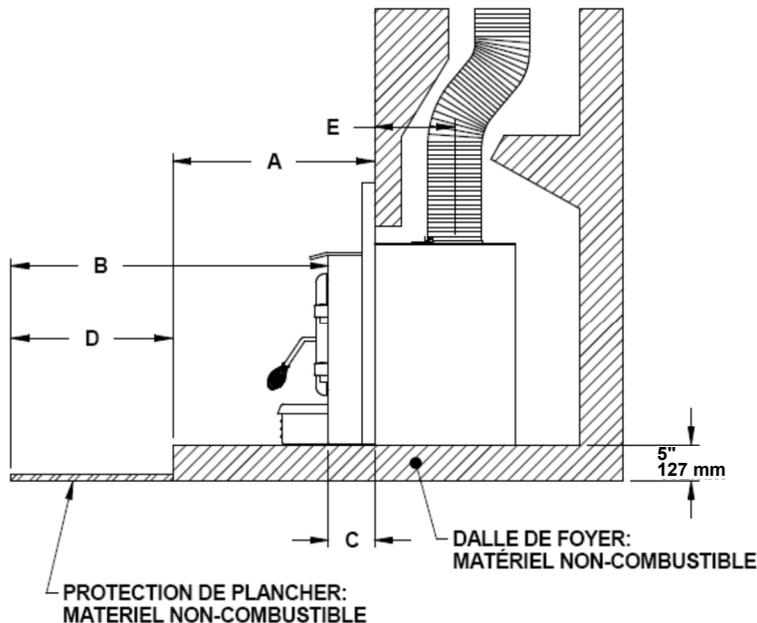
Si une protection de plancher en matériau non combustible devait être ajoutée au niveau de l'âtre de maçonnerie, un facteur R égal ou supérieur à 2,00 est nécessaire et doit se prolonger d'au moins 29" (737 mm) devant l'ouverture de la porte.
