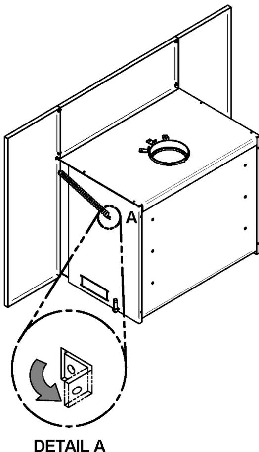
Centrez l'encastrable dans l'ouverture du foyer. Ajustez sa hauteur à l'aide des boulons de nivelage situés de chaque côté du caisson jusqu'à ce que la façade repose parfaitement sur le plancher du prolongement de l'âtre.
