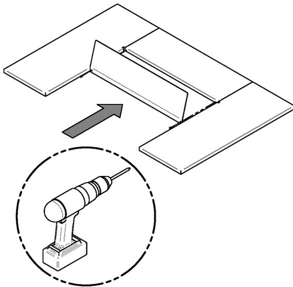
Installez l'écran coupe-chaueur sur la façade à l'aide de 3 vis auto-taraudeuses comprises dans le kit. L'écran coupe-chaueur doit pointer vers le haut.
