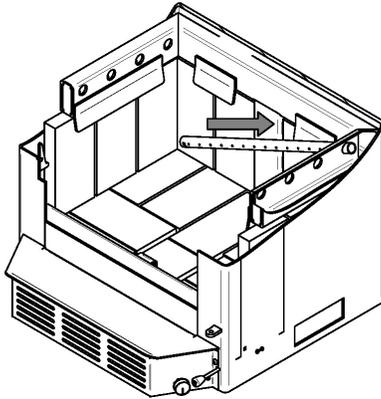
1. En commençant vers l'arrière, inclinez et insérez le tube d'air secondaire arrière dans le trou du fond de la canalisation droite. Ensuite, levez et poussez le tube vers la gauche dans le trou correspondant de la canalisation de gauche.
