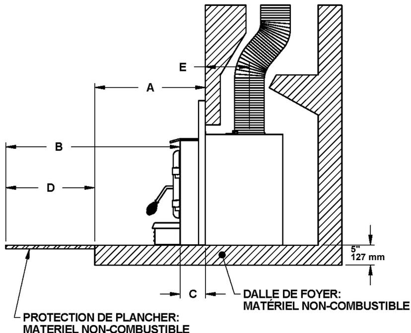
L'utilisation de la valeur R est pratique lorsque plus d'un matériau est utilisé dans la protection de plancher installé devant l'extension de l'âtre pour couvrir la surface combustible. En effet, les valeurs R sont additives, tandis que les valeurs K ne le sont pas.
