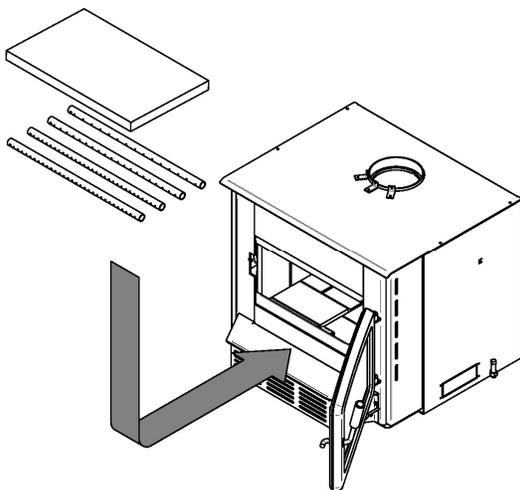
3. Répétez l'étape 1 et 2 pour les 2 tubes arrière puis installez les coupe-feu avant d'installer les 2 tubes avant.
